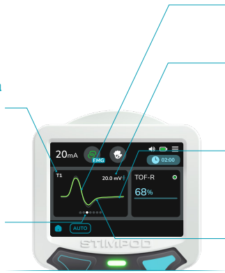
Forma de Onda de Respuesta Evocada Única Identificada
