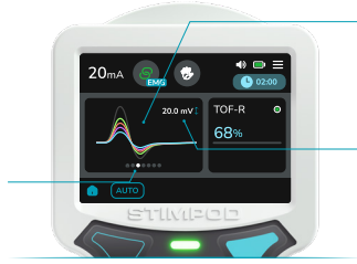
Vista de Forma de Onda de Respuesta Evocada Múltiple
