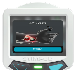
Circuito de Estimulación Abierto
